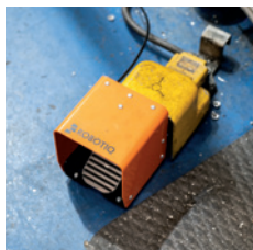
Control del sujetamiento del torno
